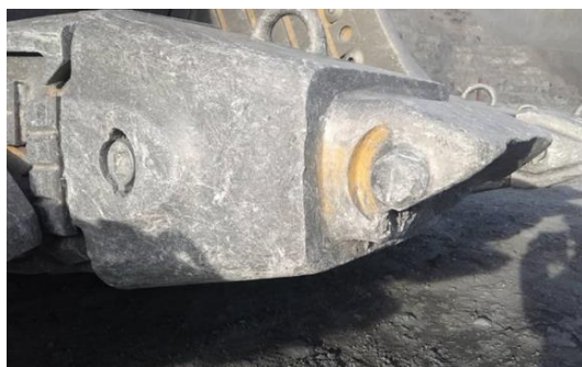
Рис.1. Износ коронки при ударной нагрузке
