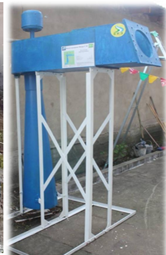
Микро ГЭС мощностью 0,2-0,5Вт
