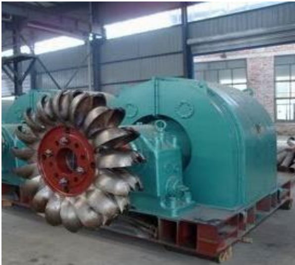
Рис.4.1. Крупный план колеса Пелтона, с детальной конструкцией ковшей.
