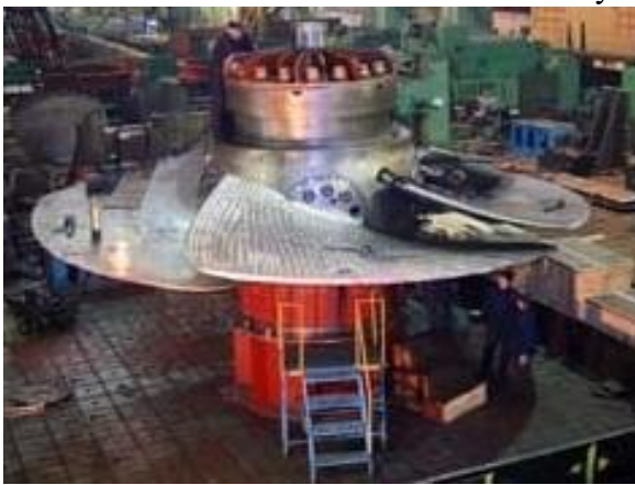
Рис.4.10. Радиально-осевая турбина типа РО-230-В-677 мощностью 650 МВт Саяно-Шушенской ГЭС
