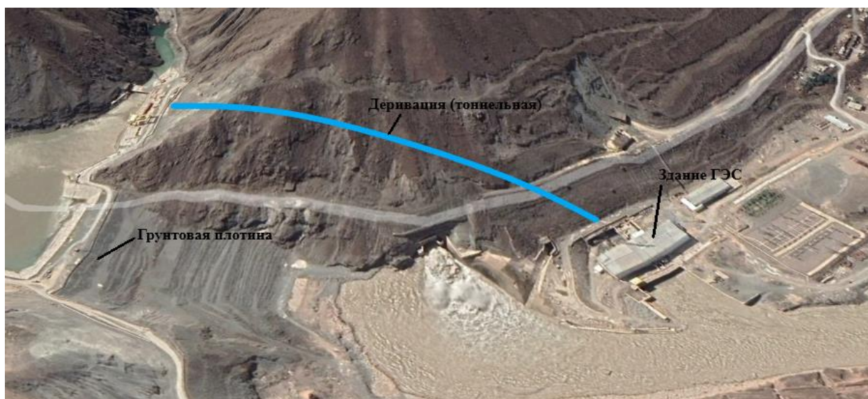
Рис.1.7. Деривационная схема (Камбаратинская ГЭС-2)
