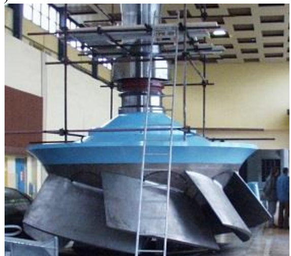
Рис.4.11. Осевые турбины: а) поворотно-лопастная турбина ПЛ 30-В-800 с установленной мощностью 82 МВт Новосибирской ГЭС; б) пропеллерная турбина; в) поворотно-лопастная диагональная турбина.
