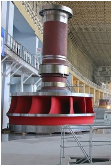
Рис.4.10. Радиально-осевая турбина типа РО-230-В-677 мощностью 650 МВт Саяно-Шушенской ГЭС
