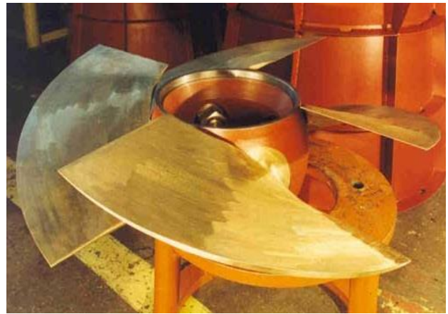
Рис.4.10. Радиально-осевая турбина типа РО-230-В-677 мощностью 650 МВт Саяно-Шушенской ГЭС
