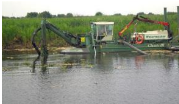
Рис.2. Земснаряд с отсасывающим насосом для очистки дна водоемов
