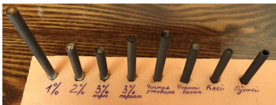
Рис. 6. Графитовые образцы для проведения спектрального анализа
