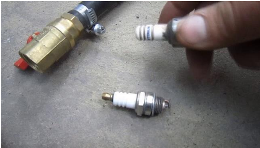
Рис.2. Применение автомобильных свеч в испытываемой форсунке
