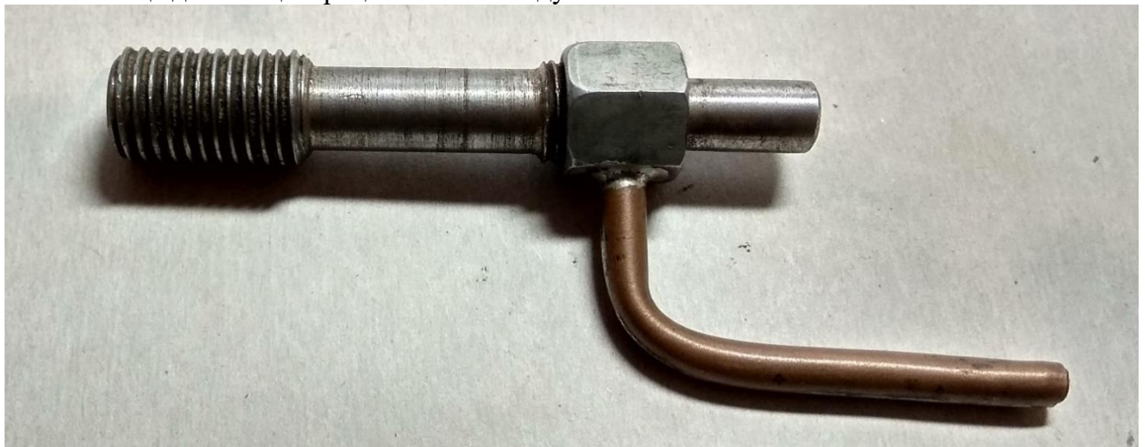
Рис. 4. Форсунка пескоструйного аппарата в сборе.
