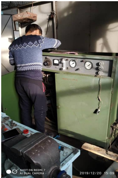
Рис.1. Ремонтно-восстановительные работы микроплазменной установки МПР-1.
