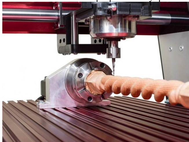
Рис. 2. Принцип работы 4-х координатного фрезерного станка с числовым программным управлением
