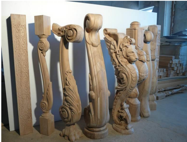
Рис. 3. Примеры изделия изготовленных на 4-х координатном фрезерном станке с числовым программным управлением
