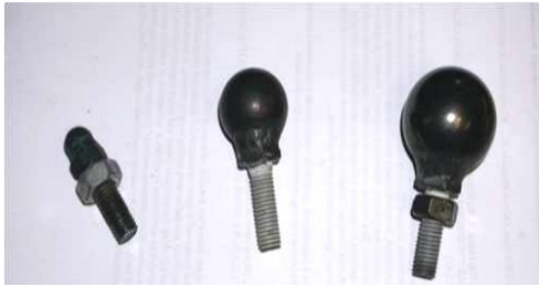
Рис. 9. Стальные инденторы, используемые при ударном нагружении
