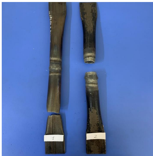
Рис. 1. Образцы сварных соединений (1,2)
