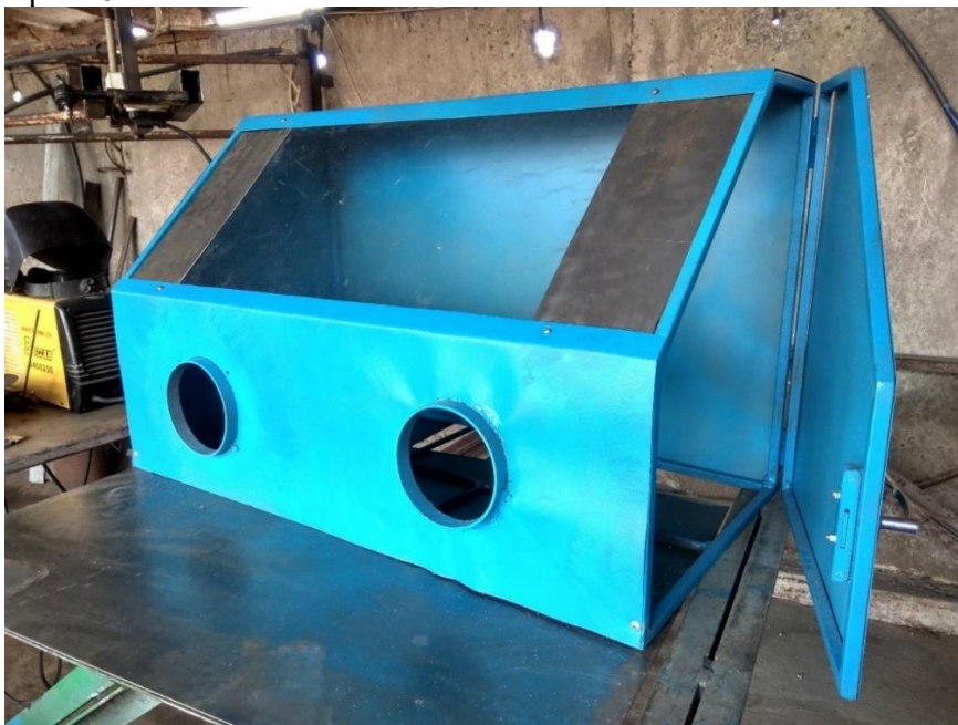
Рис. 6. Пескоструйная камера для безопасной работы
