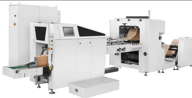
Рис 4. Линия производства бумажных пакетов
