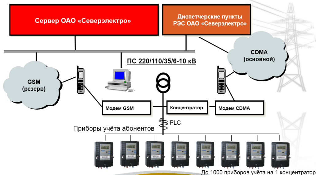
Рис.1. Структурная схема АИИСКУЭ, установленная в ОАО «Северэлектро»
