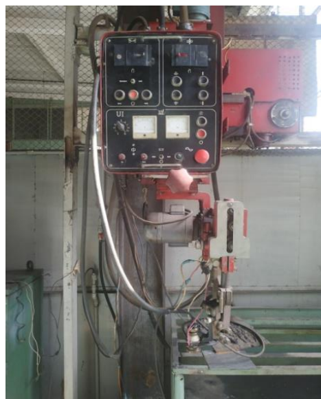
Рис.3. Самоходная тележка на котором установлен плазмотрон
