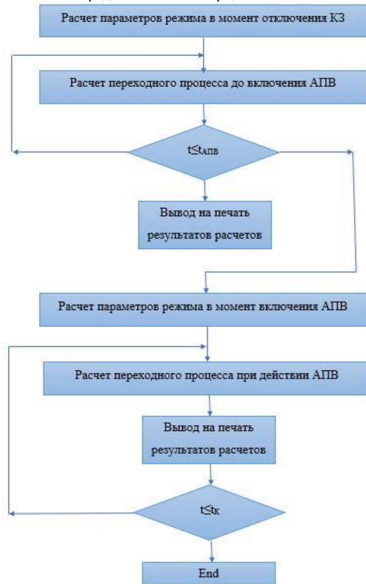
Рис. 4.11. Блок-схема алгоритма расчета электромеханических переходных процессов
