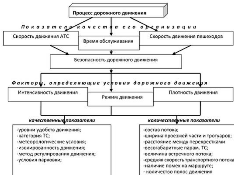
Рис.1-Процесс дорожного движения совершенствования организации грузовых перевозок в черте междугородного и на прилегающих территориях, путем оптимизации расположения складов и терминалов, выделения «специализированных» участков дорожной сети для грузового движения и т.д.; прогнозирования возникновения пробок и корректировки маршрутов движения.
