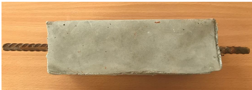
Рис. 1. Внешний вид железобетонного образца до испытаний
