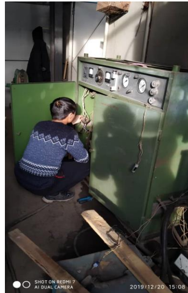
Рис.1. Ремонтно-восстановительные работы микроплазменной установки МПР-1.
