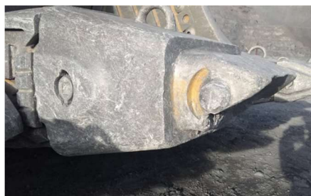
Рис.1. Износ коронки при ударной нагрузке
