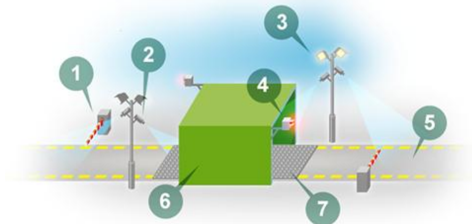
Рис.1- Схема предварительного пункта весогабаритного контроля: 1 – шлагбаум, 2 – камера обзора и распознавания регистрационного номера, 3 – мачты освещения, 4 – светофор, 5 – покрытие дорожное, 6 – навес, 7 – весы
