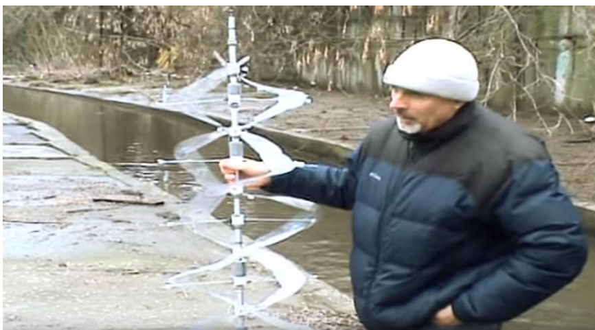
3- сүрөт. Кош бурама түрүндө жасалган Овсянкиндин кичинекей жана жөнөкөй СЭС
