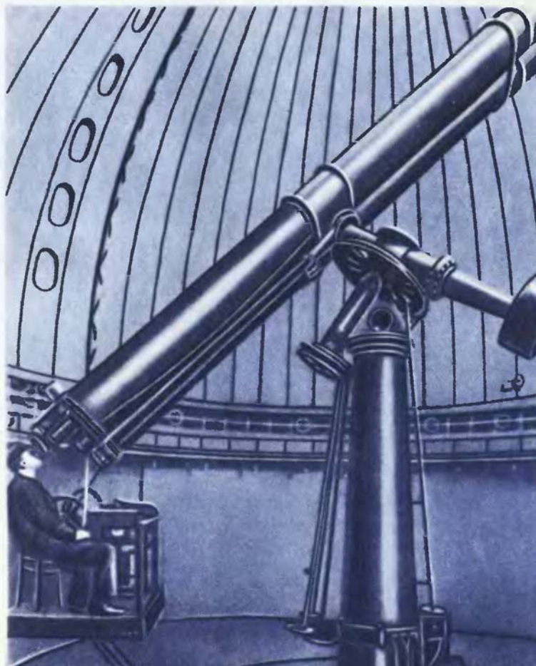
Рис. 53. Двойной рефрактор для рассматривания и для фотографирования небесных светил. Два телескопа заключены в общий кожух.
