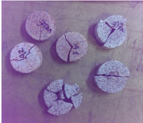
Рис.1. Виды разрушения образцов горных пород при расколе
