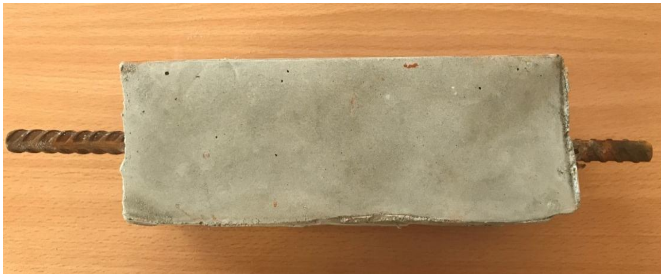
Рис.1. Внешний вид железобетонного образца до испытаний
