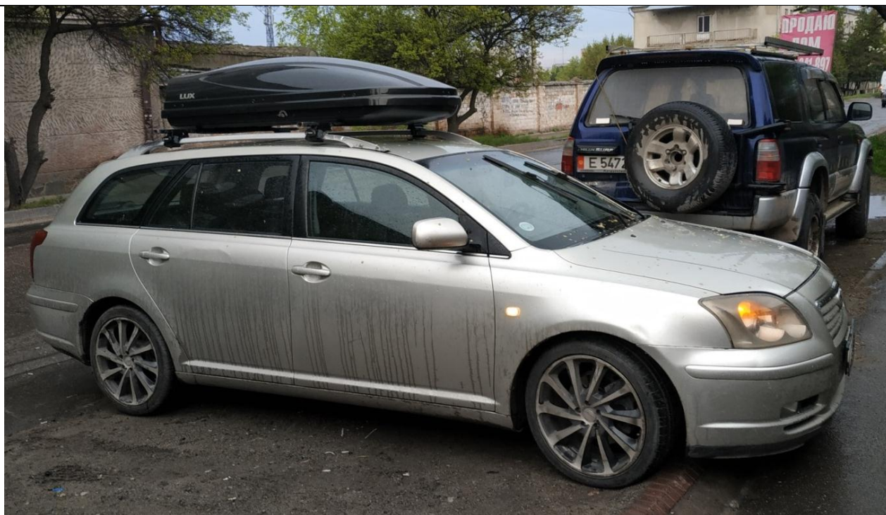
Рисунок 7 – Передвижная лаборатория на базе автомобиля Toyota Avensis с установленным аппаратным обеспечением экспериментального исследования экологических характеристик автомобилей и транспортных потоков
