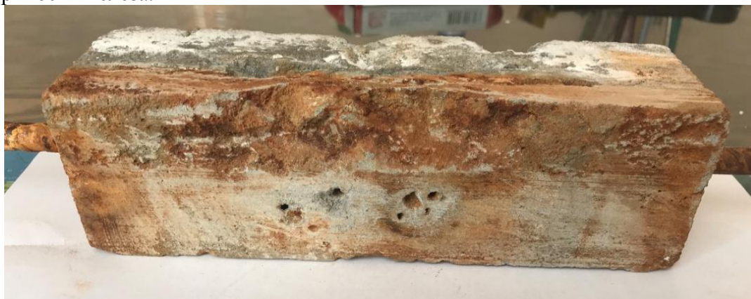
Рис. 4. Образец, подверженный электрокоррозии
