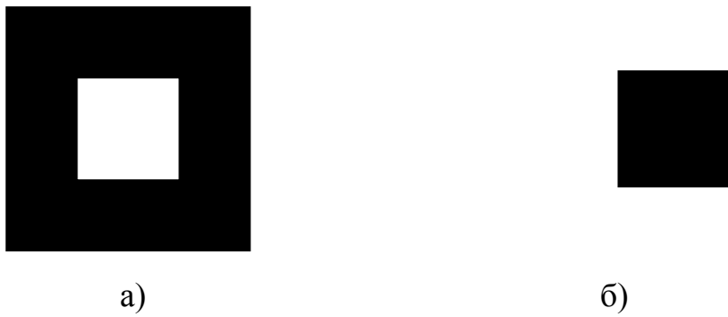
Рис.2. а- маска для измерения сигнала, б- маска для измерения шума.
